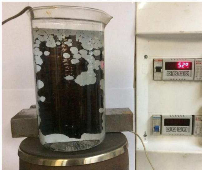
Рисунок У.3 – Внешний вид поверхности покрытия в процессе отмыва пленки нефти с его поверхности водой
