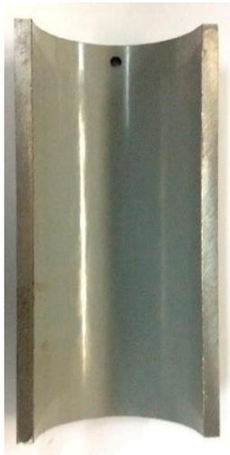
Рисунок У.1 – Внешний вид покрытия в исходном состоянии.
