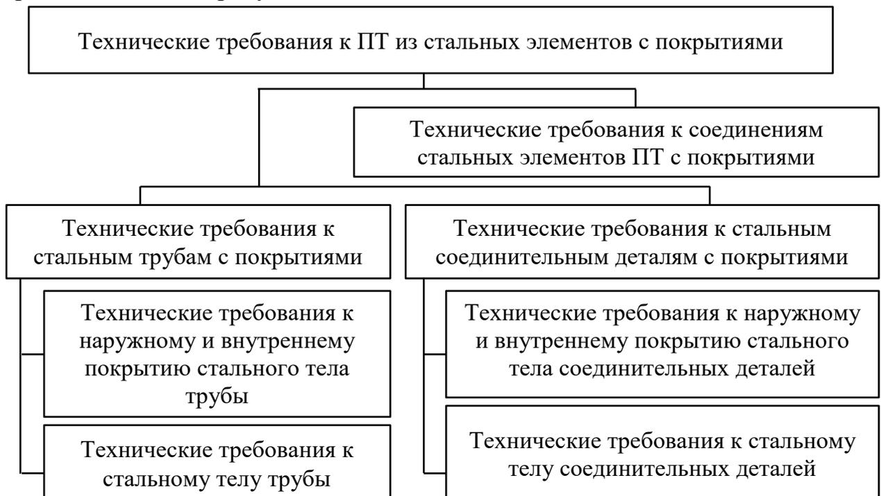
Рисунок 2 – Схема последовательности разработки технических требований к трубопроводам с наружным и внутренним покрытиями, к их отдельным элементам и к соединениям этих элементов при проектировании
